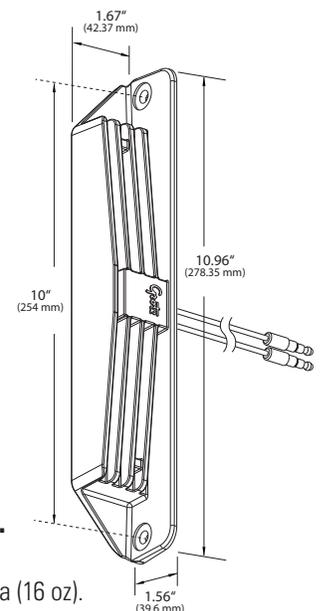
Luz LED de fuselaje. Mejora la visibilidad al atardecer y por la noche durante las inspecciones de seguridad y previas al viaje con una iluminación perimetral mejorada del remolque.
